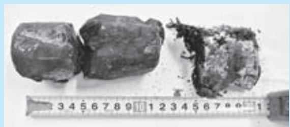
機械の損傷などにつながる金属の塊。絶対に入れないでください。
