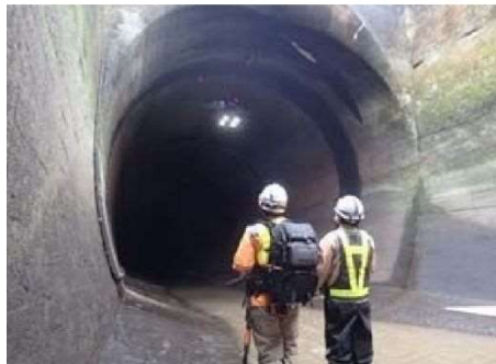
・地中レーダアンテナを搭載したドローンを、操縦によって移動する
